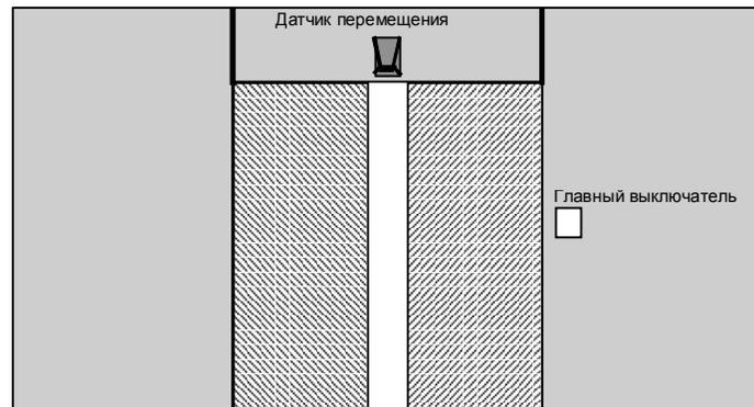
Двери обычно приводятся в движение двигателем с предохранительной фрикционной муфтой. Это препятствует тому, чтобы человек мог быть зажат или поранен дверьми. Система управления подключена к сети через главный выключатель.
